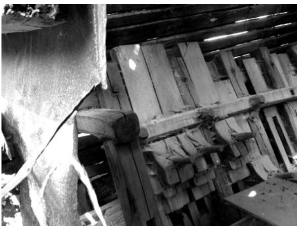
4. kép. Botok a lövétei a régi ványolóban. (BARDÓCZ-TÓDOR Enikő felvétele, 1994)
